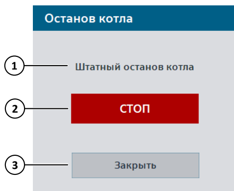
Рисунок 3-10 Штатный останов котла
